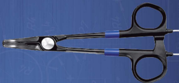
Биполярный инструмент ТЕРМОШОВ (зажим для лигирования крупных сосудов, пластиковая изоляция, длина 160 мм, два штекера 2,7 мм)
